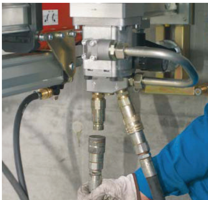
Przyłącz przewody hydrauliczne do napędu
